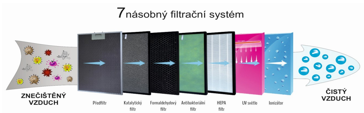
Diagram znázorňující jednotlivé filtry použité k čištění vzduchu
